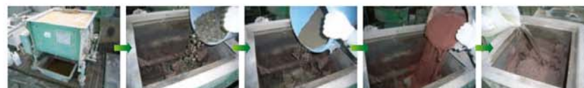
試験ミキサ 粗骨材投入 細骨材投入 下水汚泥焼却灰投入 練混ぜ水投入
