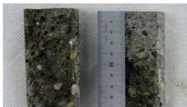
浸透深さ確認試験(参考) 【約40mmまで浸透確認】
