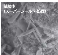
SEMによる観察写真 【ひび割れ深さ20mm部の改質確認】
